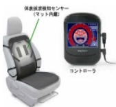
ドライバーの居眠り感知・警報装置
