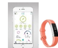
運転者の睡眠状態を測定する機器
