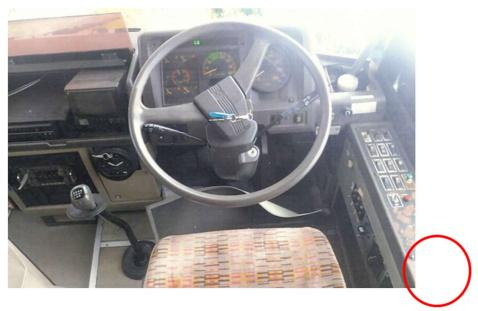
写真 7-1 運転席(○はエアコンの温度調節パネルの位置)
