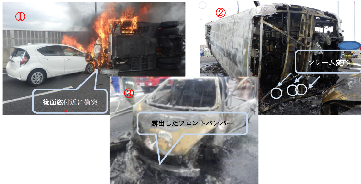
図6 当該車両及び後続車両の状況（名古屋市消防局提供）
