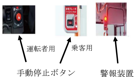
図 11 ドライバー異常時対応システムのイメージ 10
