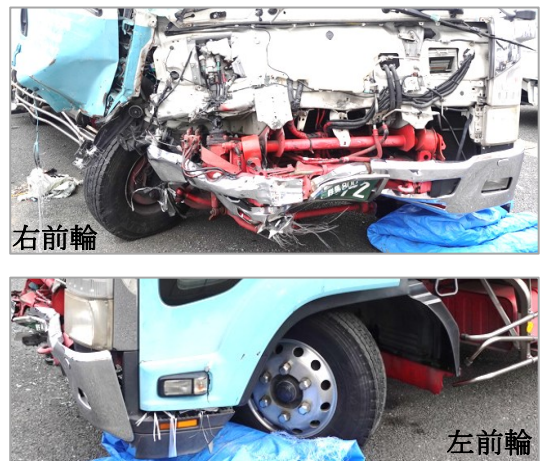
写真 4 左右前輪転舵状況
