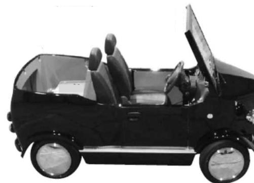
ネジ止めされた屋根を外せばオープンカーに
