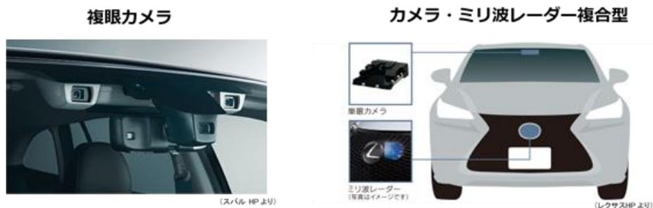
図：市販車に搭載されている、前方をセンシングするためのデバイス例
