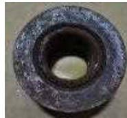
【車輪脱落事故車両のホイールナット例】ナットに錆びが発生し、ワッシャがスムーズに回転しない。ワッシャが固着して回転しないものもある。ネジ部やワッシャ摺動面には、給脂した痕跡が見られない。
