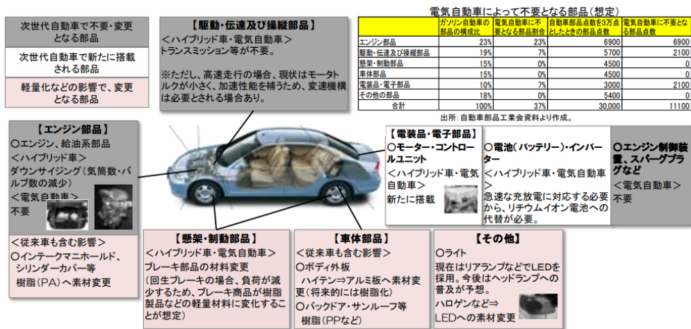
図 1-4 ガソリン車と電動車に必要な部品の違い
