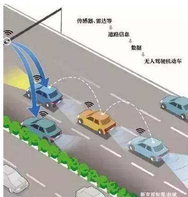
全長97km、内側2車線が自動運転車両専用レーンとなる構想
