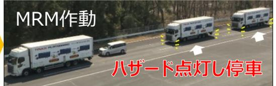
重大な故障状態により、隊列走行の継続が困難な場合に作動し、後続車は、安全な速度で減速し、自動で停止する
