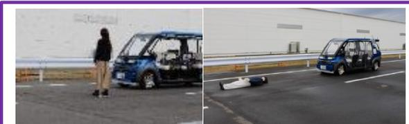
障害物検知・車両制御試験の様子
