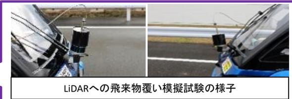
LiDARへの飛来物覆い模擬試験の様子
