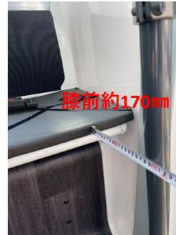
○基準に適合させるために実施した改造事例
