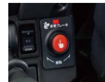
運転者用非常停止ボタン
