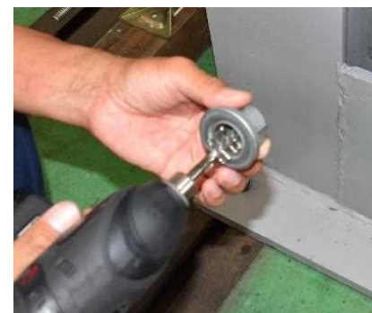
電動式ワイヤーブラシを使ったナットの清掃及び パーツクリーナーによるナット摺動面清掃
