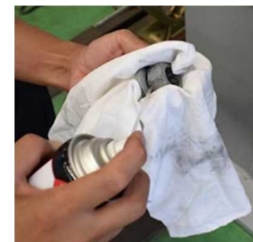
電動式ワイヤーブラシを使ったナットの清掃及び パーツクリーナーによるナット摺動面清掃
