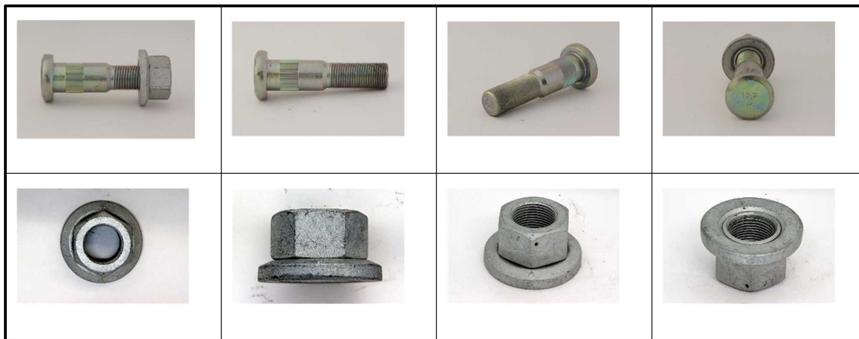
試験1で使用したホイール・ボルト、ナット
