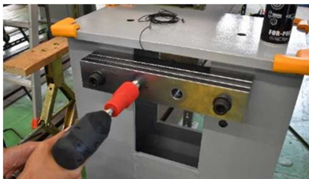
電動式ワイヤーブラシを使ったボルトの清掃
