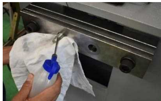
ボルトのねじ部の給脂
