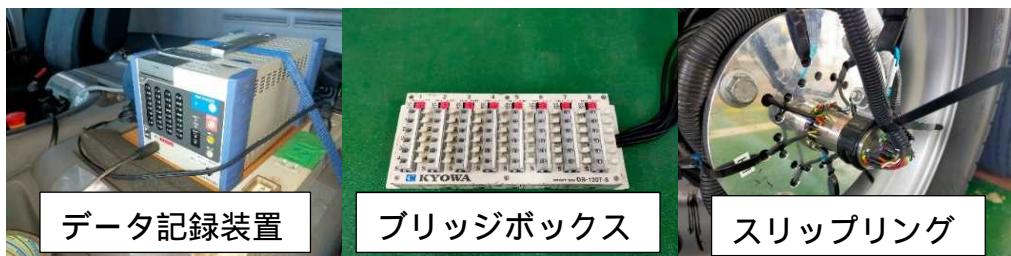
図 6-5 . 試験に使用した計測器
