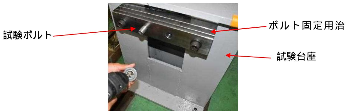
図 5-5. 試験用治具の外観
