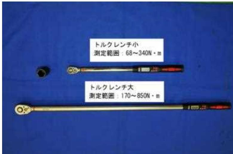
図5-6. ナット締め付けに使用したトルク・レンチ
