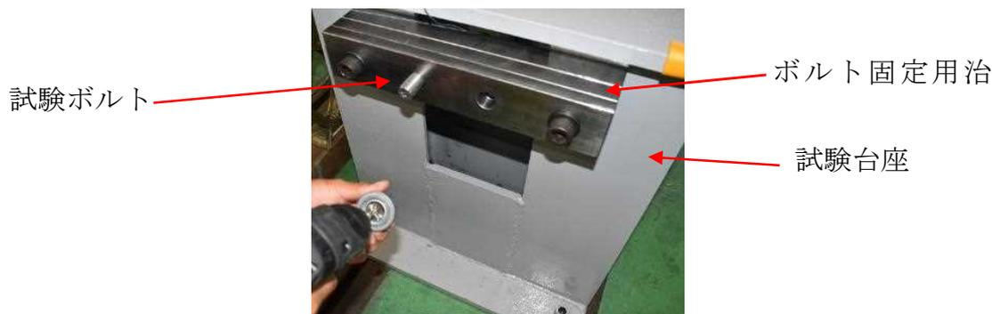
図 5-5. 試験用治具の外観
