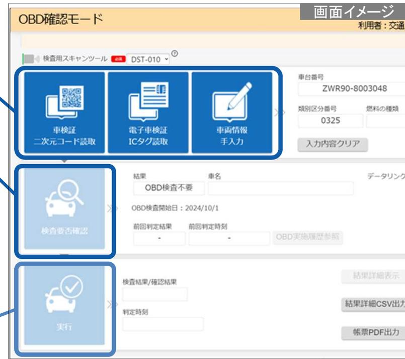
OBD検査開始後の運用と同様の手順で習熟していただく必要があるため、**完成検査時における練習**は、「OBD**検査**モード」で実施してください。ただし、プレ運用期間中は法令適用前なので、システム上でも「OBD検査を実施する」ことはできません。**受入点検時等**に、「OBD**確認**モード」で判定結果確認までの一連の操作の練習を行ってください。
