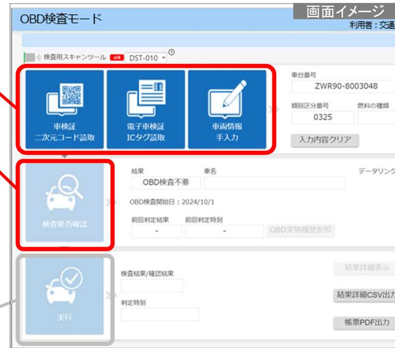
OBD検査開始後の運用と同様の手順で習熟していただく必要があるため、**完成検査時における練習**は、「OBD**検査**モード」で実施してください。ただし、プレ運用期間中は法令適用前なので、システム上でも「OBD検査を実施する」ことはできません。**受入点検時等**に、「OBD**確認**モード」で判定結果確認までの一連の操作の練習を行ってください。
