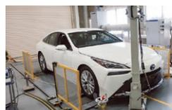
乗用車を用いた流量測定試験
