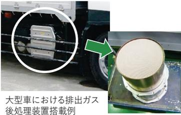
大型車における排出ガス後処理装置搭載例
