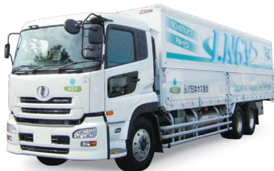
大型液化天然ガス (LNG, Liquefied Natural Gas) 自動車は、液化された天然ガスを燃料としています。気体の天然ガスに比べエネルギー密度が約3倍あることから、同一容量であれば一充填で約3倍の航続距離が可能となります。ディーゼル車と同等の航続距離を達成するために新たな液化天然ガス燃料供給装置と車両を開発・試作しました。
