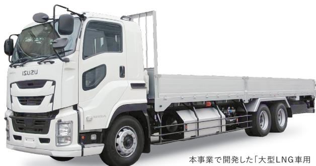
本事業で開発した「大型LNG車用燃料システム」を搭載した試験車両
