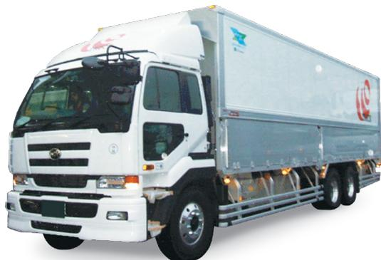
圧縮天然ガストラック (CNG, Compressed Natural Gas) 自動車は、圧縮された天然ガスを燃料としています。CNG自動車は、粒子状物質を排出しないクリーンな自動車であるとともに、天然ガスが世界各地で豊富に産出されることから、エネルギーセキュリティの観点からも優れた自動車です。
