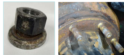
著しいさびや汚れが確認されたナット・ボルト
