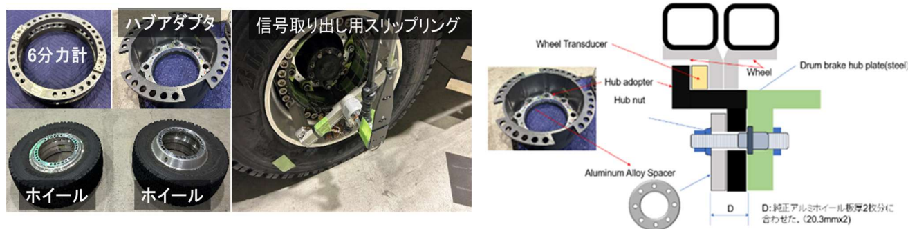
図 3.4.3 6 分力計および搭載構造
