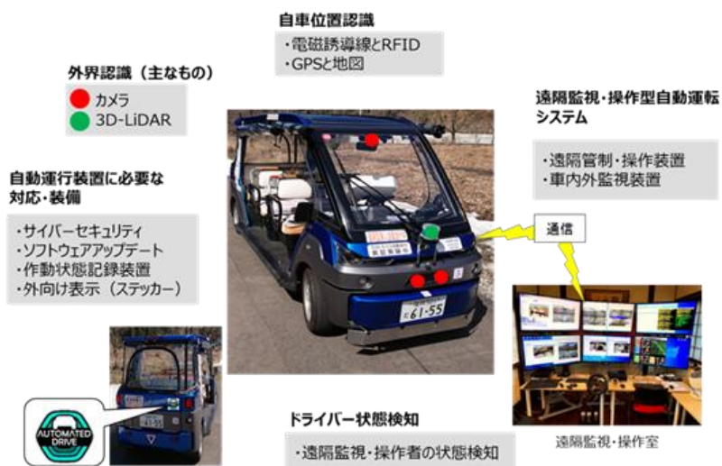
図 1-2-8. 福井県永平寺町ラストマイル自動運転車両の主な自動運行装置の構成
