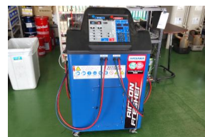
冷媒洗浄装置
