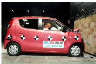
（図 3）JNCAP における荷重分布測定（フルラップ衝突）
