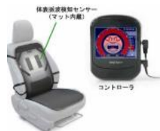
ドライバーの居眠り感知・警報装置
