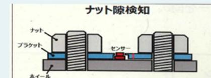
ナットに、センサーのついたナットキャップを取付け、ナットのゆるみによるキャップの回転を検知し、運転者席に警告を表示
