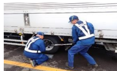
トルク・レンチによりナットの緩みを確認
