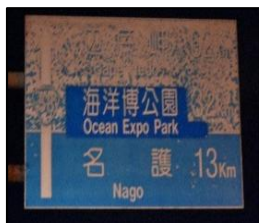
【視認性が低下した標識の事例】
