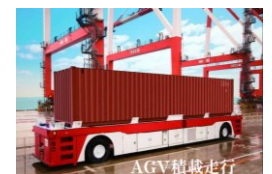
AGV積載走行 出典：飛島コンテナ埠頭株式会社 コンテナドレージの自動運転
