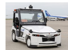
空港制限区域内の 自動運転トーイングトラクター
