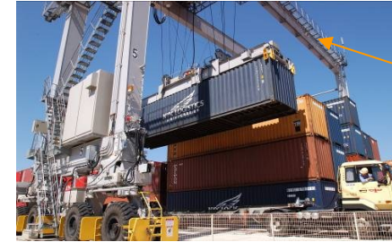
遠隔操作RTG
