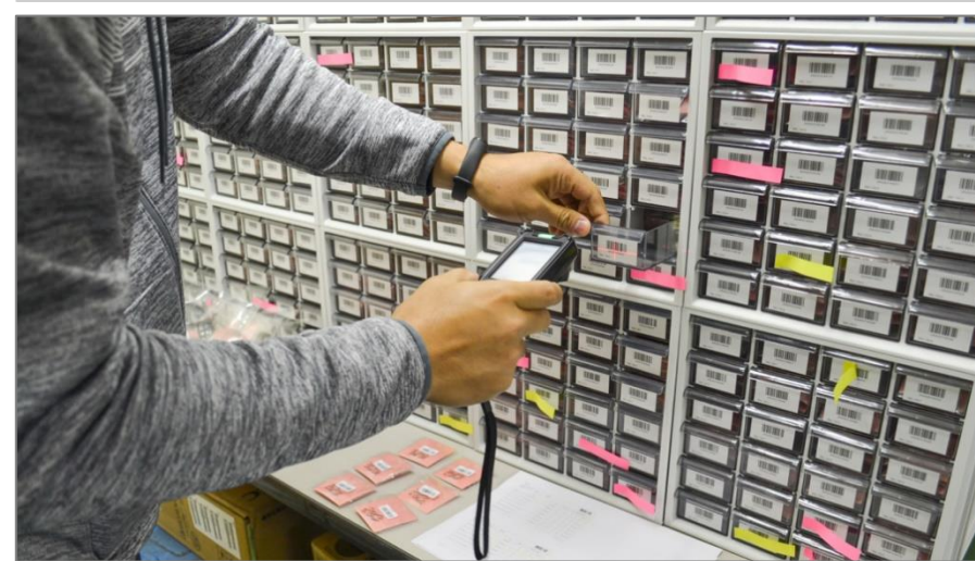
WMSと連携されたバーコードによる検品
