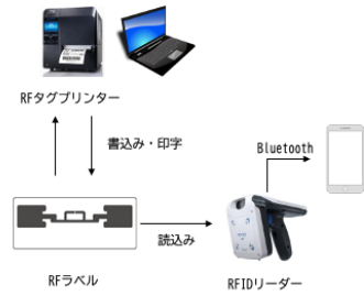
RFID実証実験 システム構成図
