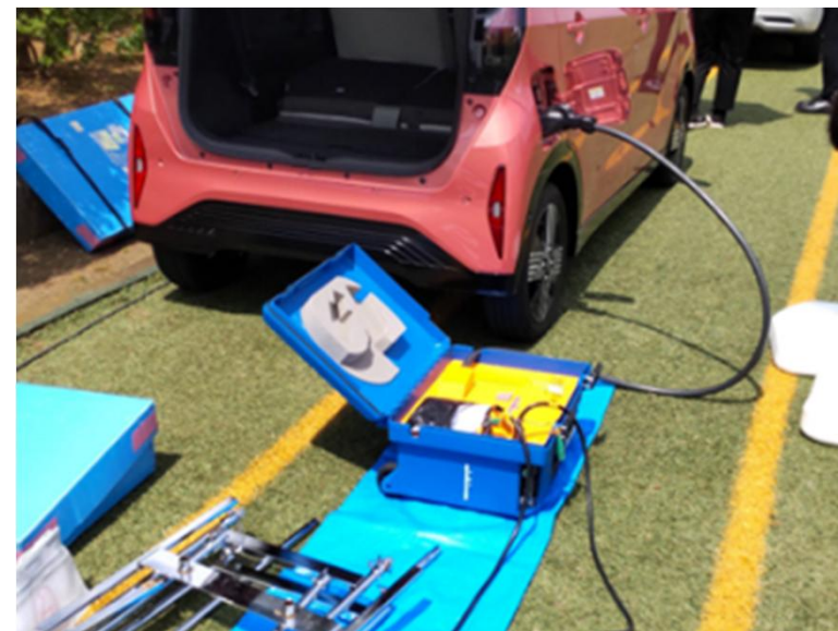
【可搬型給電器による給電】
