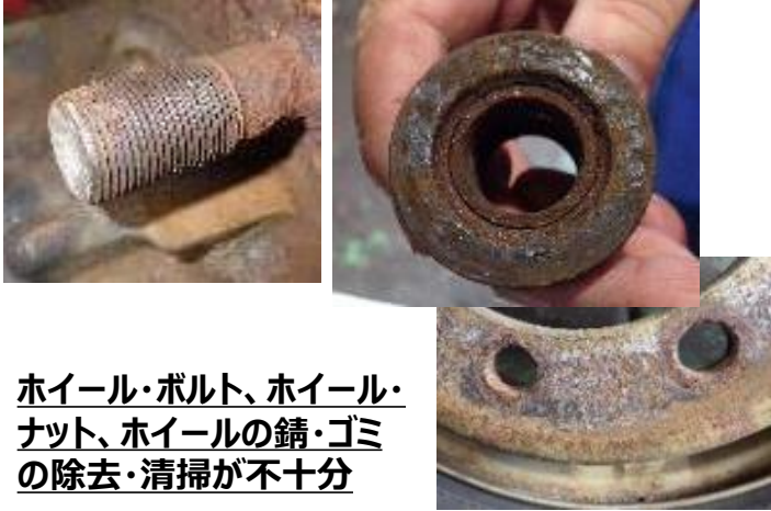
再現 再現 ↑ ホイール・ナットとワッシャのすき間の清掃、エンジンオイルなどの潤滑剤を塗布していない
