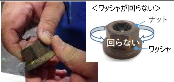
再現 再現 ↑ 規格の締め付トルクで締め付けられていない
