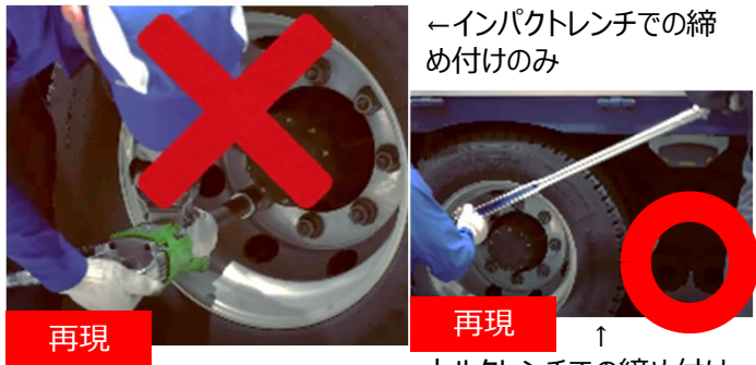
再現 再現 ↑ 規格の締め付トルクで締め付けられていない
