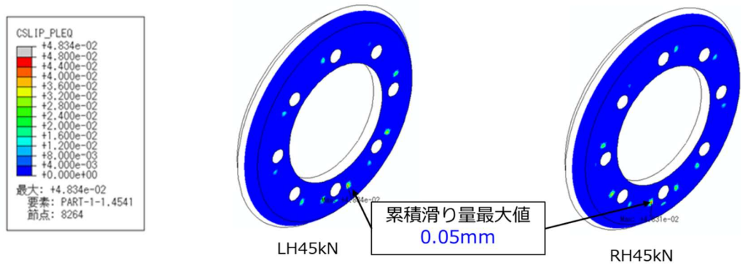
図 5-4-1.ホイール間の接触面の累積滑り量分布 (45kN)
