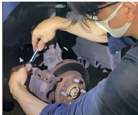
ディスクブレーキのブレーキパッド交換
