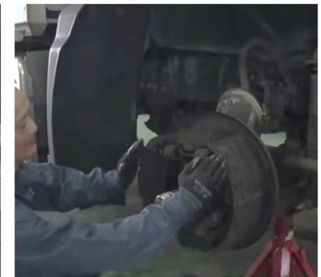
ドラムブレーキのブレーキライニング交換
