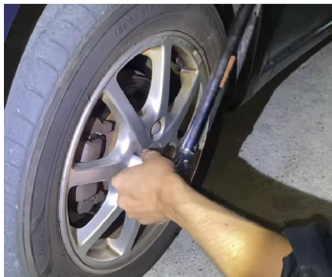
ディスクブレーキのブレーキパッド交換
