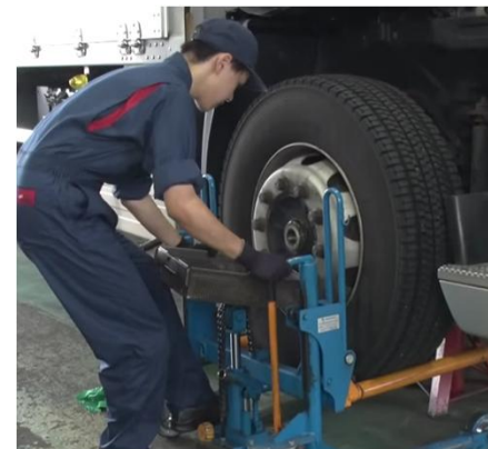
ドラムブレーキのブレーキライニング交換
