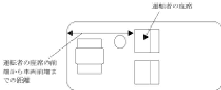
ロ 運転者席及びこれと並列の座席のうち自動車の側面に隣接する座席の前方にある部分の表面が、衝撃を緩衝する材料で覆われ、かつ、鋭い突起を有していないもの
