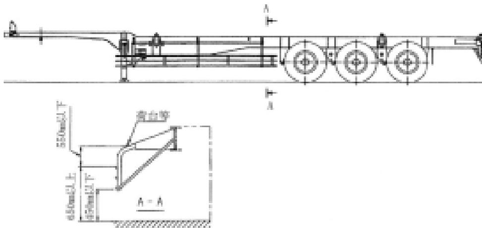
三 巻込防止装置は、その平面部（湾曲部を除く。以下同じ。）前端を含み車両中心面に対して直角をなす鉛直面と前輪タイヤのうち最後部にあるものの後端を含む車両中心面に対して直角をなす鉛直面との距離及び平面部後端を含む車両中心面に対して直角をなす鉛直面と後輪タイヤのうち最前部にあるものの前端を含む車両中心面に対して直角をなす鉛直面との距離が400mm以下となるように取り付けられていること。ただし、セミトレーラに備える巻込防止装置にあっては、その平面部前端が補助脚より前方となるように取り付けられていなければならない。
