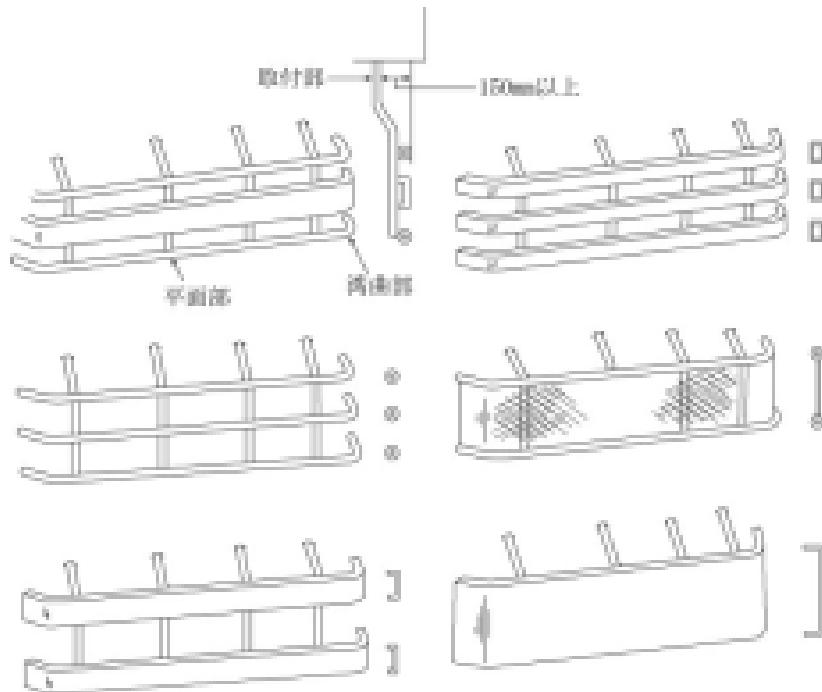
五　巻込防止装置は、振動、衝撃等によりゆるみ等を生じないように確実に取り付けられていること。
