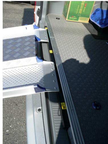
スロープ端部(車両側)は段差の生じないような処理がなされており、スロープ板が左右にずれないようにすき間を埋めるブロックが付属している。
