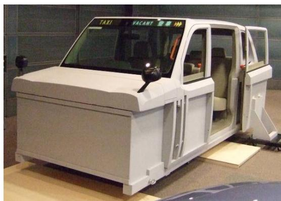
図5.2 品評会で用いた一般UDタクシーに相当するモックアップ
