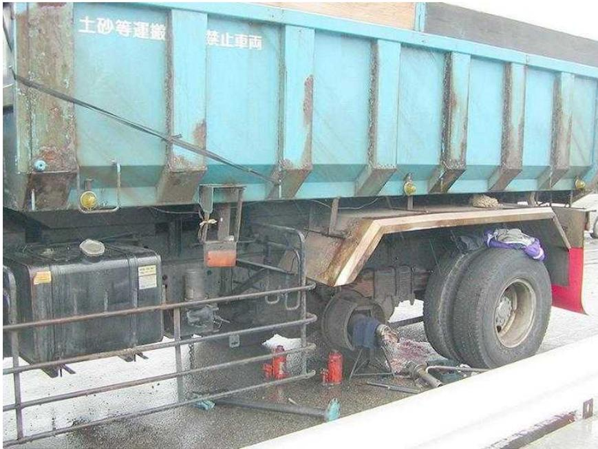
図表 17 ホイール・ボルトが全て折損したハブ
