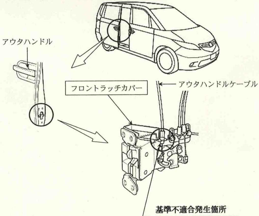
スライドドアのフロントラッチカバーの排水位置が不適切なため、排水された水がアウトハンドルケーブル下端に付着し、アウトハンドル操作時に水滴がケーブル内に引き込まれるものがある。そのため、低温時に水滴が凍結し、アウトハンドルでドアを開けた場合にケーブルの摺動抵抗でハンドルが戻らず、ドアを閉められなくなるおそれがある。
