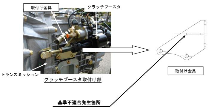
クラッチ倍力装置の取付け金具の強度が不足しているため、エンジン高回転時の共振により、当該金 具に亀裂が発生する場合がある。
