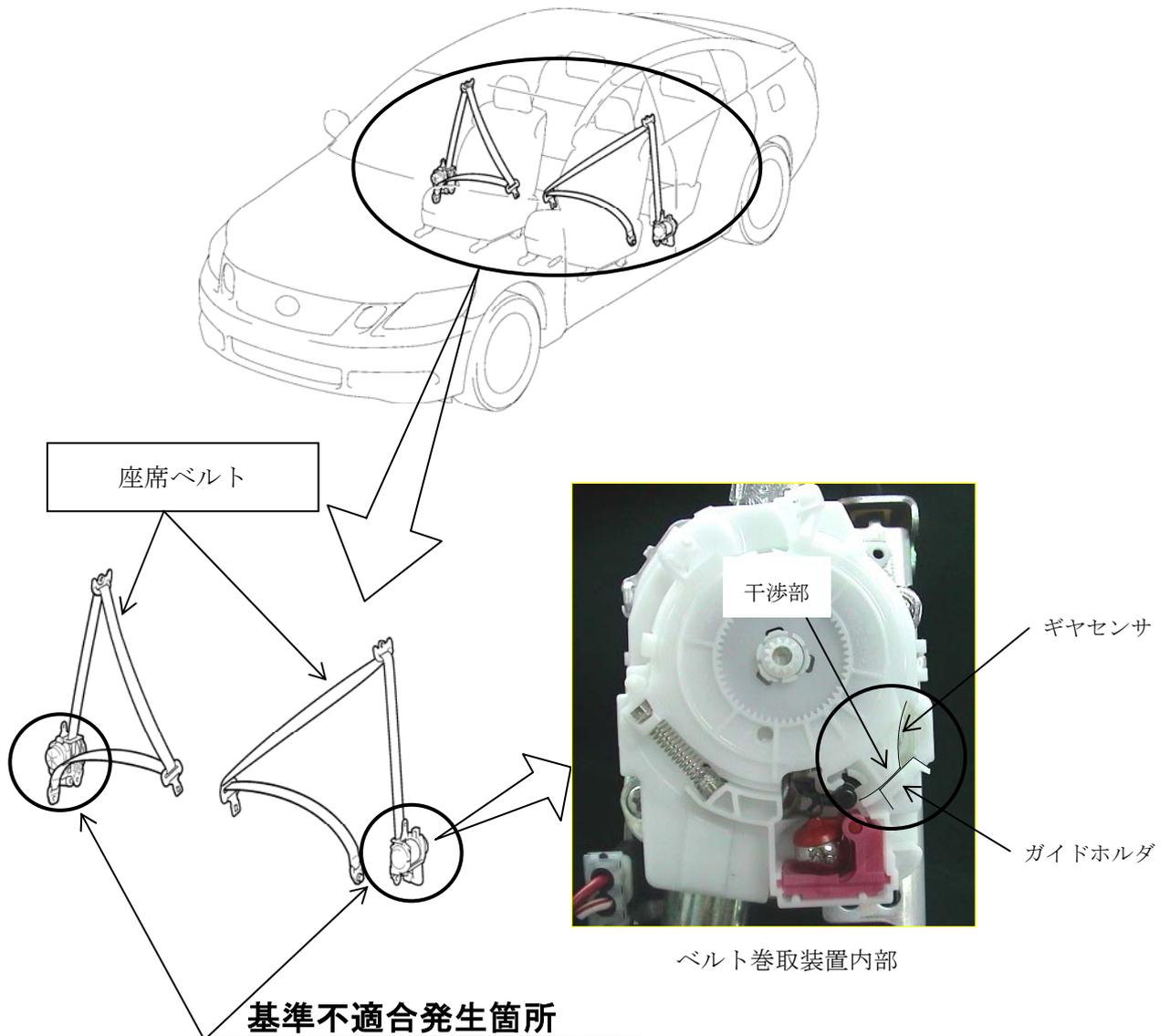
運転者席及び助手席用座席ベルトの巻取装置内部の部品に製造不良のものがあため、ロック機構のギヤセンサ端部とガイドホルダが干渉し、座席ベルトを引き出せないことがある。そのため、当該ベルトが装着できず、乗員を拘束できなくなるおそれがある。
