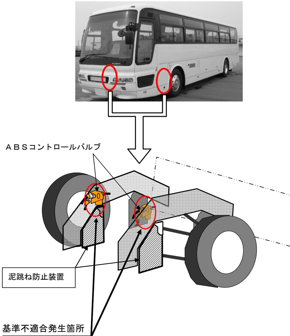
製造工程において、前輪内側前部に装着する泥跳ね防止装置に形状の異なるものを誤って取付けたため、雪路走行時に巻き上げた雪がABSコントロールバルブのエア排気口を閉塞することがあり、ABSが機能しなくなるおそれがある。
