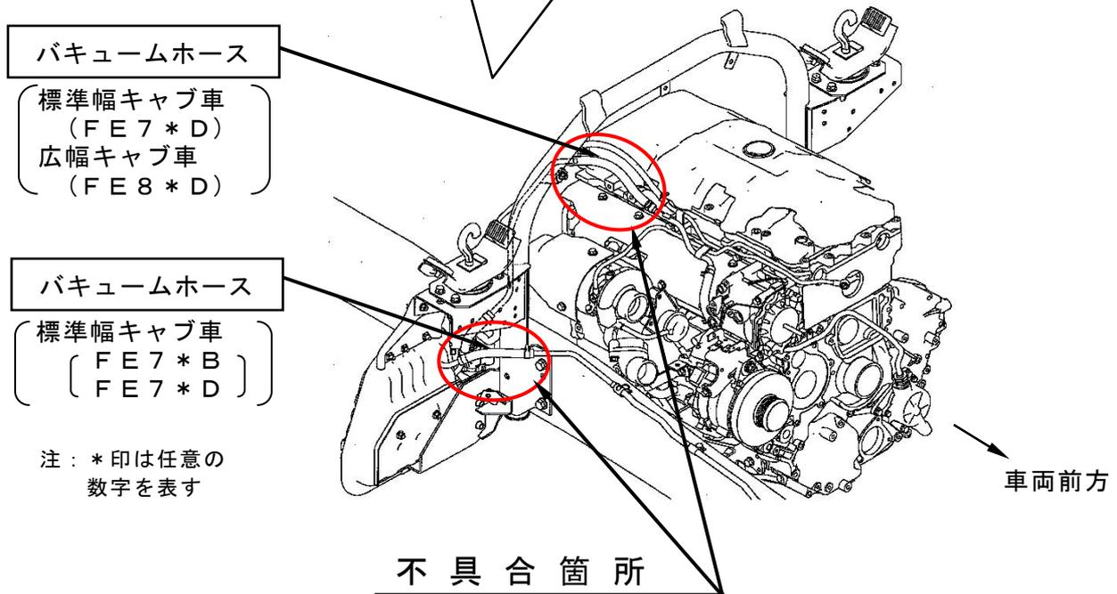
負圧式制動倍力装置のバキュームホースの成形が不適切なため、負圧により変形し、当該ホースの内部が狭くなることがある。そのため、きわめて短時間に制動操作を繰り返し行くと、倍力機能が低下し、最悪の場合、制動距離が運転者の予測より長くなるおそれがある。
