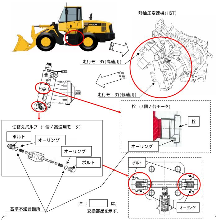
静油圧変速機の走行モータの切替えバルブにおいて、左右のボルトの締付けトルクが不適切なため、除雪作業時等の作動油が高圧となる条件下で繰り返し使用するとボルトが緩むものがある。そのため、そのままの状態で使用を続けると、オーリングが破損して作動油が流出し、最悪の場合、走行不能になるおそれがある。
