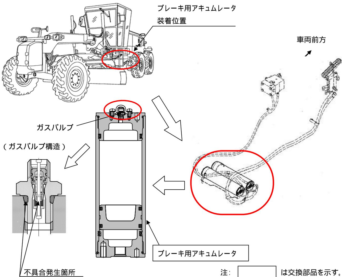
ブレーキ用アキュムレータのガス注入バルブのシール性が不足しているため、ガスが漏れることがある。そのため、そのまま使用を続けると、ガスの圧力が低下し、最悪の場合、制動停止距離が伸びるおそれがある。
