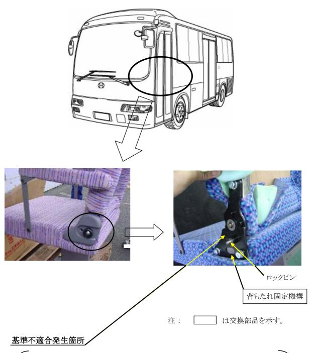
乗合バスの車椅子固定部に装着した折りたたみ式座席の背もたれ固定機構のロックピンの強度が不足しているため、背もたれが折りたたまれた状態から背もたれを起こす際に誤った操作を行うと、ロックピンが変形するものがある。そのため、背もたれを起こした時に、当該ロックピンがロックされないことがあり、背もたれが確実に固定されず、最悪の場合、停車時等に乗客が背もたれを支えにするなどした場合、背もたれが倒れ、乗客が転倒等するおそれがある。
