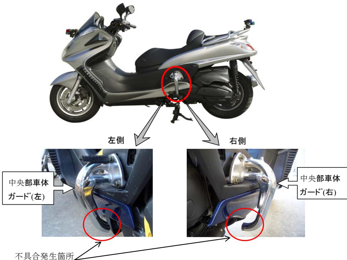
転倒時に外装部品の破損を防止するため、教習車に装着した中央部車体ガードにおいて、ガードパイプ下側の先端切断部が露出しているため、転倒した際に、乗員の足が路面と当該パイプの間にはさまれることがあり、最悪の場合、当該パイプ先端部で足を負傷するおそれがある。
