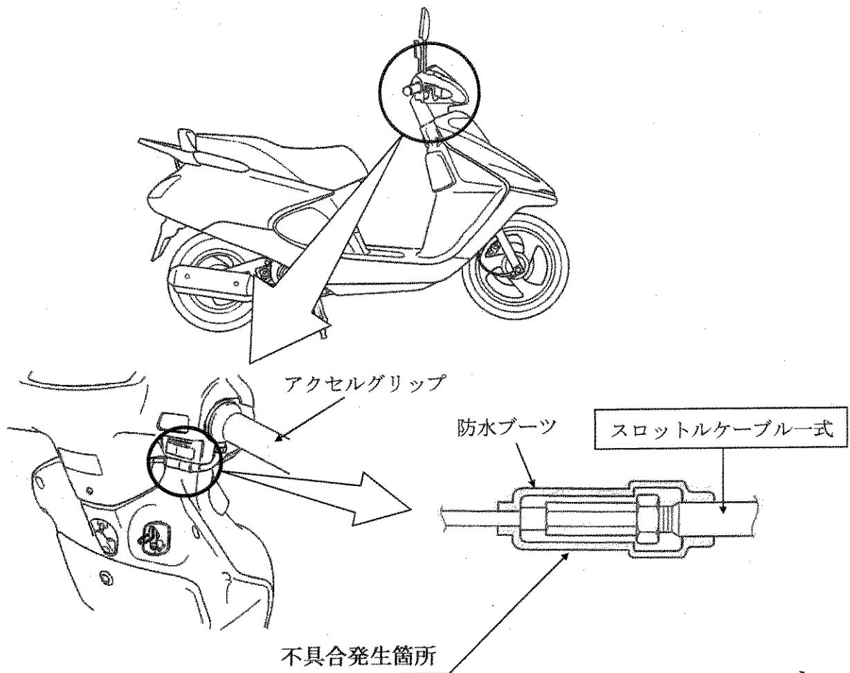
[ 改善対策時の防水ブーツの点検作業指示が不適切なため、適正な点検交換作業がされなかつたものがある。そのため、そのまま使用を続けると、ケーブルが錆び、最悪の場合、アクセルグリップが戻らなくなり、エンジンの回転が下がらなくなるおそれがある。 ]
