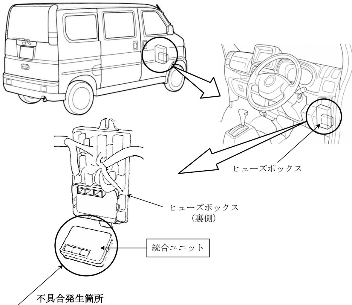
キーインタロック機構（ATのPポジション以外でキーが抜けない機構）を制御する統合ユニット（ICU：インテグレートッドコントロールユニット）の回路が不適切なため、イグニッションをオフにした際、回路が燃料ポンプからの誘導起電圧の影響を受け、キーインタロックソレノイドの作動開始が遅れることがある。そのため、ATセレクトレバーがPポジション以外の時に、短時間にキーを抜く操作を行うとキーが抜けてしまい、駐車ブレーキをかけ忘れていた場合、駐車中に車両が動き出すおそれがある。
