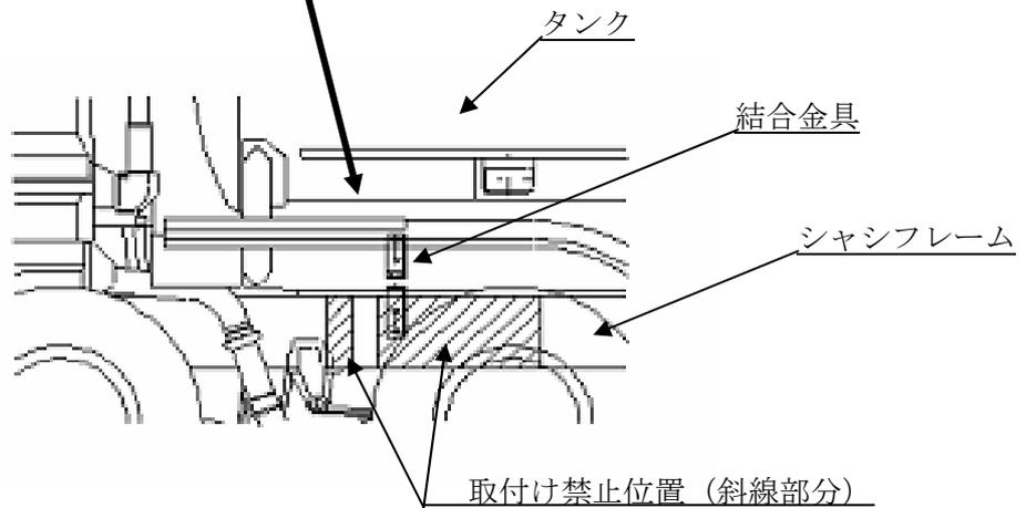
タンクローリにおいて、タンクとシヤシフレームを結合する金具の取付位置が不適切なため、当該金具取付部付近のフレームに亀裂が発生するものがある。そのため、そのままの状態で使用を続けると亀裂が進行し、最悪の場合、フレームが折損し、走行不能となるおそれがある。
