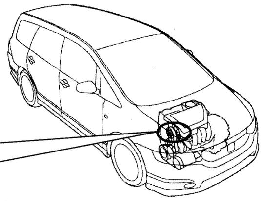
パワーステアリング用油圧ポンプの取付構造が不適切なため、補機駆動用ベルトの張力により、ポンプ締付けボルトの締付け力が低下するものがある。そのため、そのまま使用を続けると、締付けボルトが折損し、最悪の場合、油圧ポンププーリから補機駆動用ベルトが外れ、ハンドルの操作力が増大するおそれがある。
