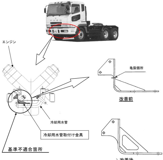
変速機に装着されている流体式補助ブレーキ装置の冷却用水管を支持する 取付け金具の強度が不足しているため、走行時の振動により当該金具が 亀裂、折損するものがある。そのため、そのままの状態で使用を続けると、 冷却用水管をつなぐホースが外れて、エンジン冷却水が大量に流出し、 エンジンの焼付きにより走行不能となるおそれがある。
